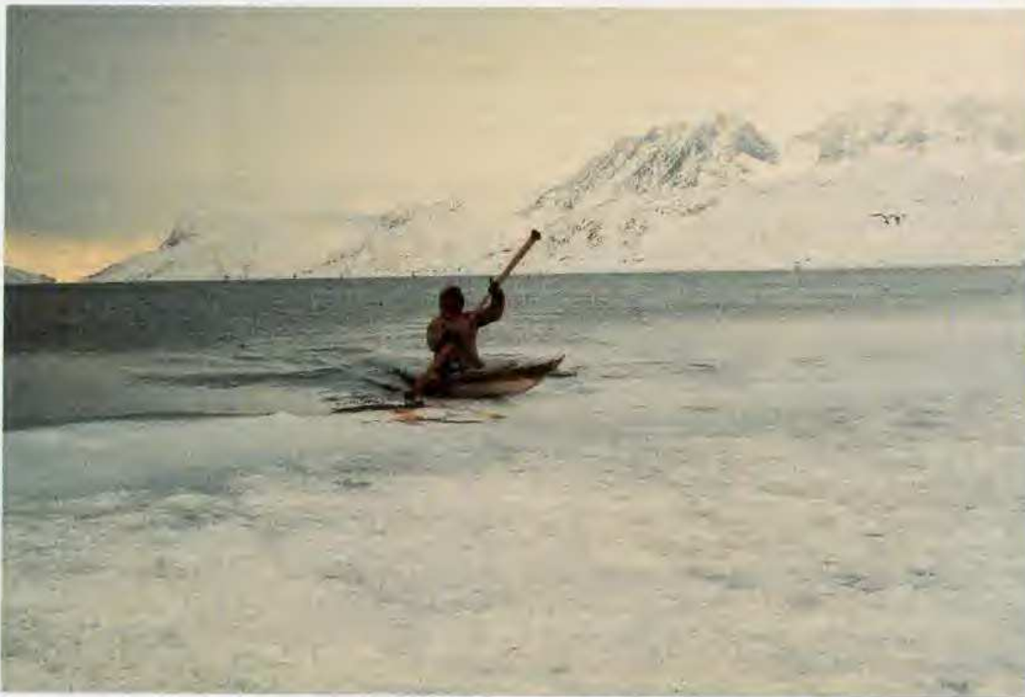
FIG. 134. — Passage en kayak sur la glace de mer en formation; Erinarteeq Jonathansen, mars 1972. L'allongement de l'étrave facilite la montée sur la glace et la forme particulière des extrémités, kattut , de la pagaie double, permet d'y prendre appui.
